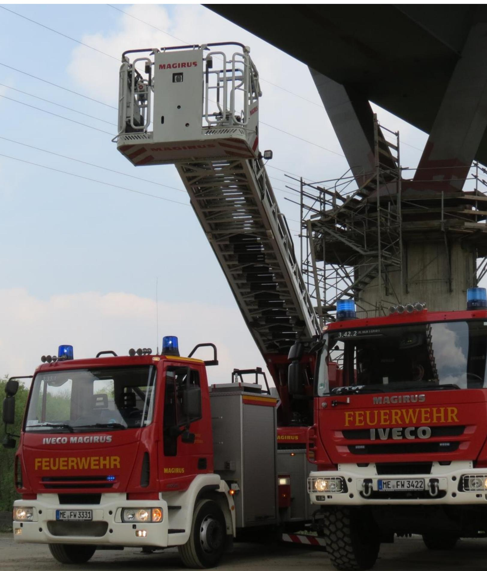
*Drehleiter (DL(A)K 23-12) und Löschgruppenfahrzeug (LF 10) unter der neuen Autobahnbrücke „Ganslandsiepen“*
